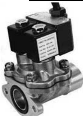
Клапан электромагнитный предназначен для управления потоком топлива, обеспечивая снижение расхода топлива перед окончанием выдачи дозы и прекращение подачи топлива после выдачи заданной дозы. Электромагнитный клапан имеет три состояния: закрыт, открыт на малый поток, открыт на большой поток. Управление состоянием клапана осуществляется путём подачи и снятия питающего напряжения. Управление клапаном обеспечивается электромагнитными катушками, которые при
