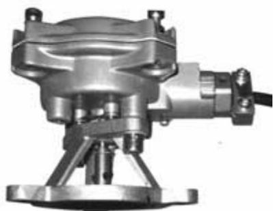
Датчик расхода топлива применяется для преобразования механического вращения вала измерителя объёма в количество последовательных электрических импульсов, используя при этом оптический метод. Валу датчика расхода передаётся вращение от измерителя объёма. На валу закреплён диск с прорезями, при вращении которого формируются два импульсных сигнала, со разницей по фазе 90°. Количество формируемых датчиком импульсов пропорционально объёму выданного топлива.
