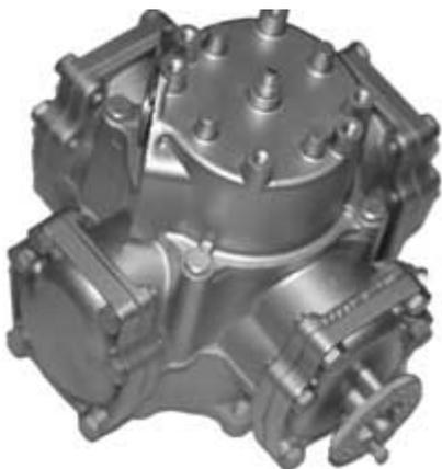
Измеритель объёма предназначен для измерения количества жидкости, проходящего через ТРК в единицах объёма. Он представляет собой четырехцилиндровый гидравлический двигатель приводимый в движение протекающим через него топливом.
