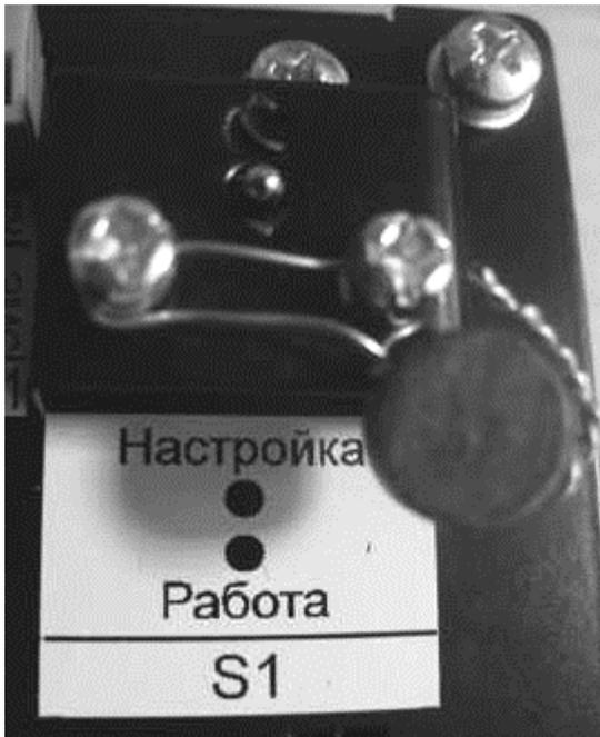
Рис.3. Пломбировка тумблера «Настройка/Работа» блока управления
